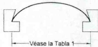
Figura 11. Condición de flexión completa
