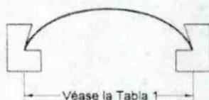
Figura 11. Condición de flexión completa
